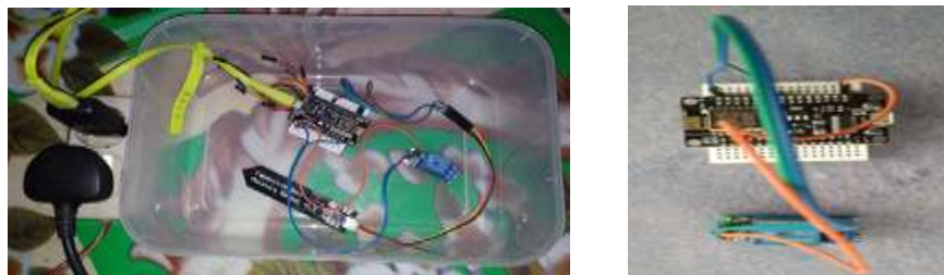
Gambar 6. Hasil Rangkaian relay ke nodemcu
