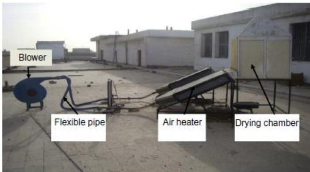
Gambar 11. Diagram skematik pengering surya tidak langsung konveksi paksa[10]
