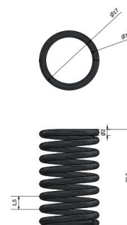
Gambar 2. Panjang Akhir Pegas Kopling Original
