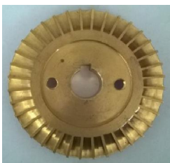
Gambar 3. Impeller Pompa tidak dilapisi Setelah dii Lakukan Pengujian Korosi.
