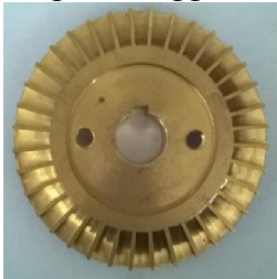
Gambar 1 Impeller kuningan tidak dilapisi
