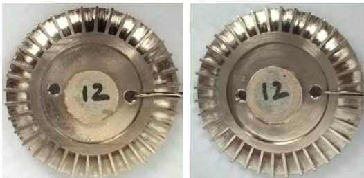
Gambar 2. Pelapisan Nikel (Ni) Selama 8 Me-nit sebelum dilakukan pengujian korosi
