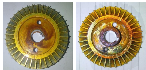
Gambar 6. Impeller Setelah Dilapisi nikel dilakukan Pengujian Korosi selama 60 jam sampai 160 jam.
