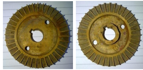
Gambar 4. impeller kuningan setelah di lakukan pengujian laju korosi selama 60 jam.
