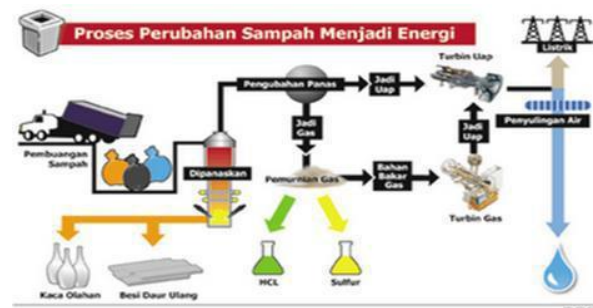
Gambar 2. Proses Kerja PLTSA Thermal Dengan Gasifikasi
