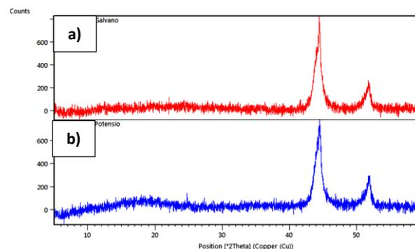
Figure 8. X-ray Diffraction Pattern PANI(galvanostatik)-Fe/Ni b) PANI(potentiostatik)-Fe/Ni
