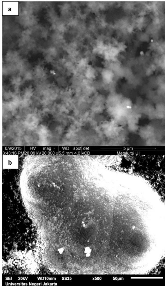
Figure 4. SEM micrograph a) PANI b) PANI-Fe/Ni
