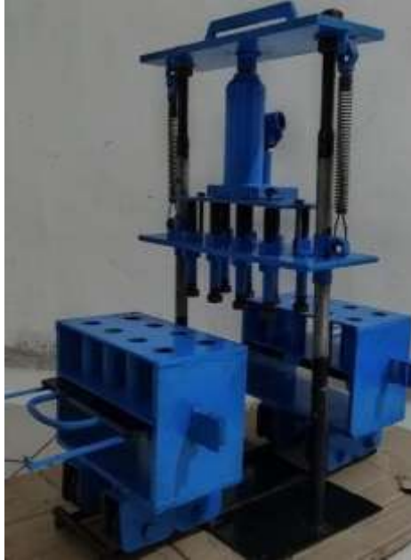
Gambar 3.1. Alat cetak briket hidrolik dengan sistem gerak rel
