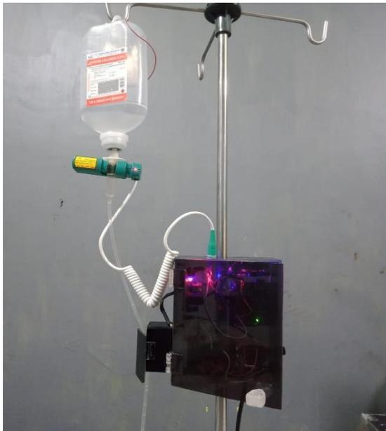
Gambar 3 Desain Keseluruhan alat monitoring cairan infus
