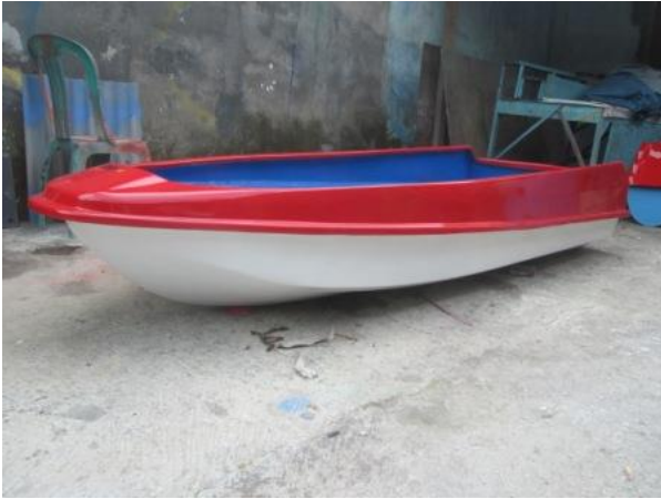
Gambar 4. Perahu Fiber Setelah Dilakukan Pengecatan
