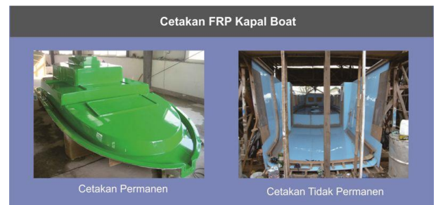
Gambar 1. Cetakan FRP Kapal Boat Permanen dan Tak Permanen
