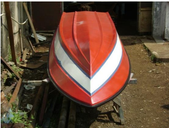
Gambar 2. Perahu Fiber Setelah Diberi Gelcoat
