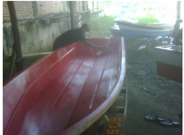
Gambar 3. Perahu Fiber Setelah Dilakukan Penambalan
