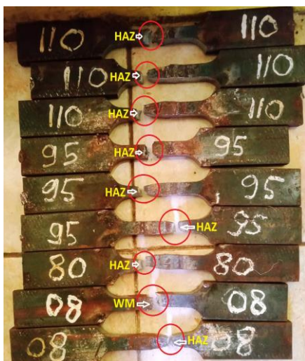
Gambar 4. Posisi patahan hasil uji tarik
