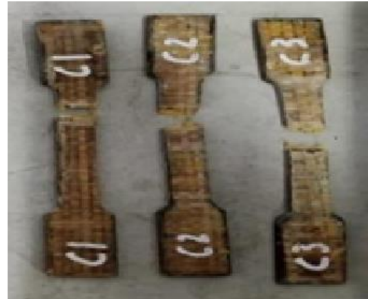
Gambar 12. Hasil uji tarik variasi 90^{\circ}
