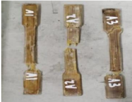
Gambar 10. Hasil uji tarik variasi 0^{\circ}
