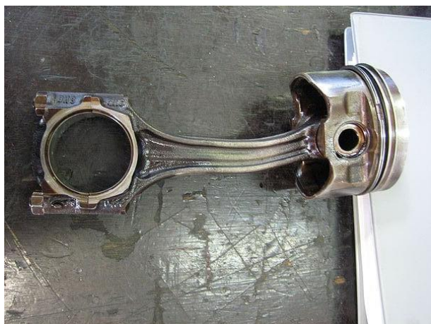
Gambar 2. Kegagalan connecting rod (Sumber: Putra, 2020)
