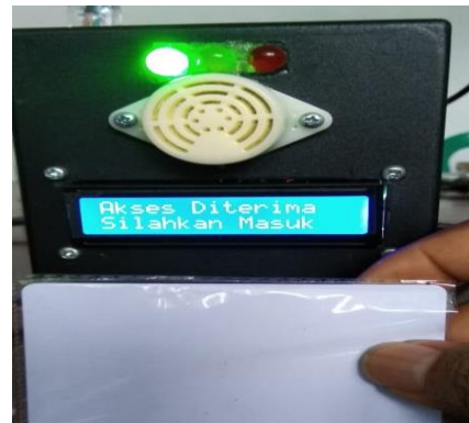
Gambar 4. Pengujian E-KTP dan RFID Tag Card setelah didaftarkan
