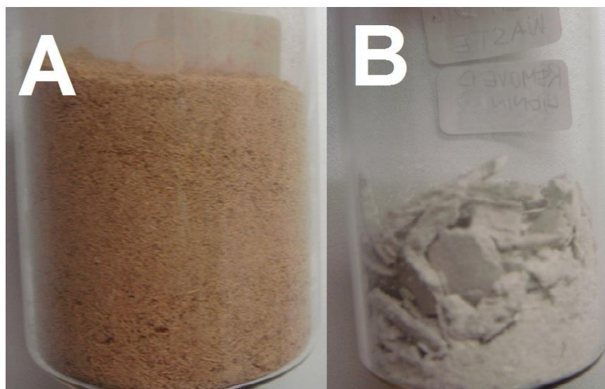
Gambar 1. Perubahan warna TKKS sebelum (A) dan sesudah (B) proses delignifikasi menggunakan \text{NaClO}_2 .
