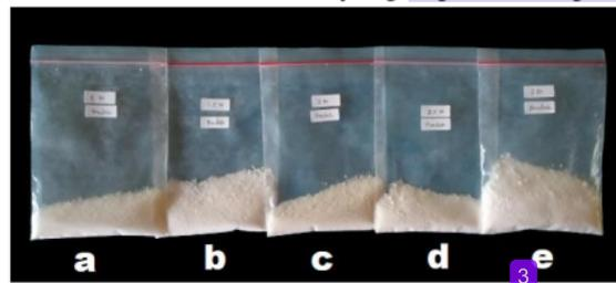
**Gambar 3.** Serbuk silika hasil variasi konsentrasi NaOH: (a) 1,0M (b) 1,5M; (c) 2,0M; (d) 2,5M; (e) 3,0M
