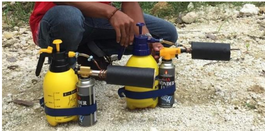
Gambar 4 Hasil Rakitan Fogging Mini
