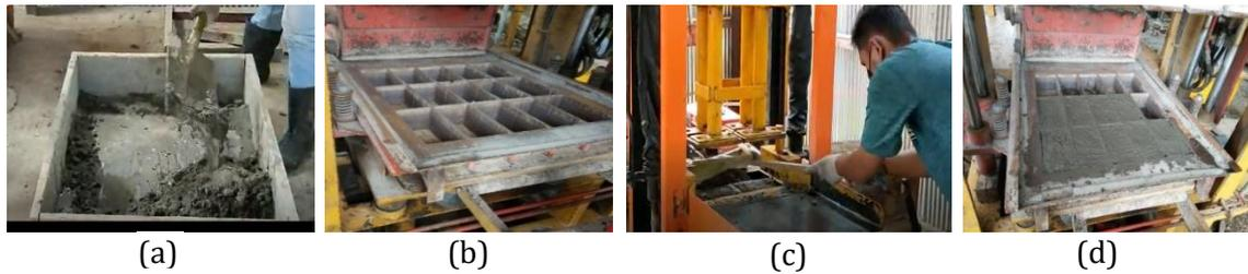
Gambar 6. Proses demo pembuatan dan *pressing eco paving block* abu tempurung kelapa
