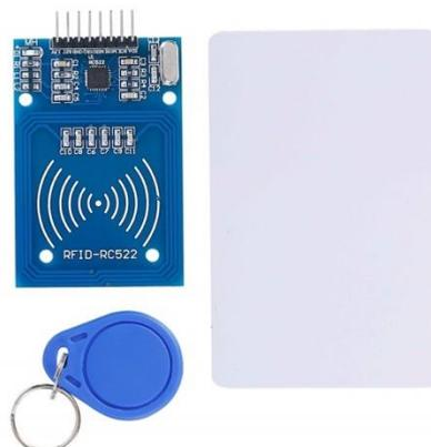
Gambar 3. Bentuk Fisik RFID
