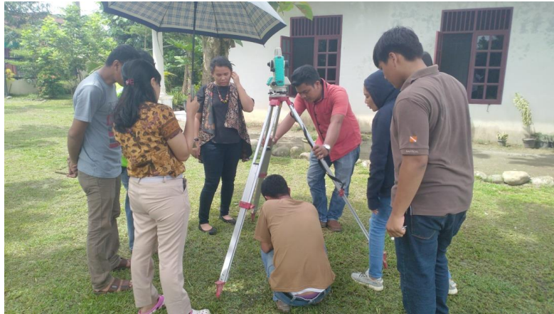
Gambar 6. Praktek Lapangan Cara Stel Alat Theodolite
