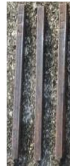
Gambar 3. Spesimen uji profil baja segiempat
