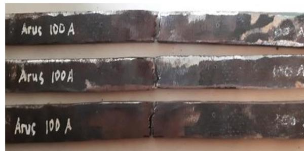
**Gambar 10.** Patahan Spesimen Pengelasan 100A
