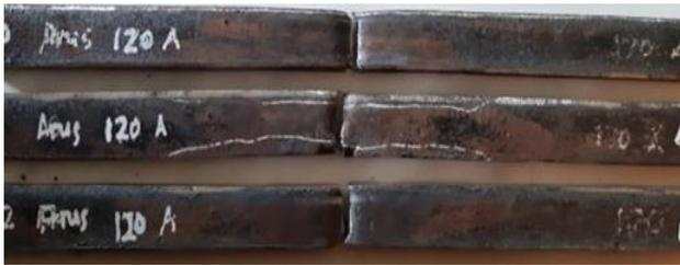
**Gambar 12.** Patahan Spesimen Pengelasan 120A
