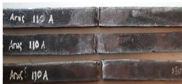
**Gambar 11.** Patahan Spesimen Pengelasan 110A
