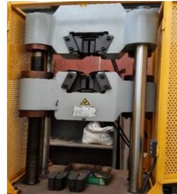
**Gambar 9.** Monitor dan Mesin Uji Tarik (Sumber: Laboratorium Kontruksi Teknik Sipil UNP)
