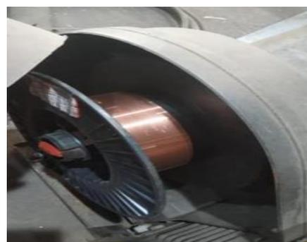
**Gambar 6.** Elektroda Las MIG ER70S-6
