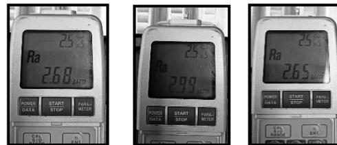
Hasil dari pengujian *specimen 3* menggunakan parameter *spindle speed* 1700 rpm, *feed rate* 350 mm/menit, *depth of cuts* 0,2 mm dapat dilihat pada tabel 4.
