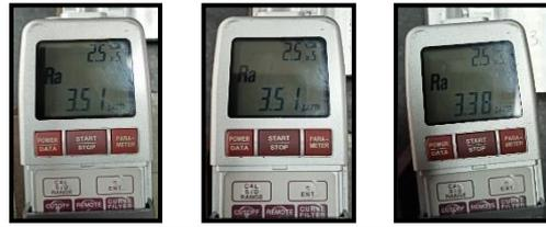
Hasil dari pengujian *specimen 2* menggunakan parameter *spindle speed* 1500 rpm, *feed rate* 350 mm/menit, *depth of cuts* 0,2 mm dapat dilihat pada tabel 3.
