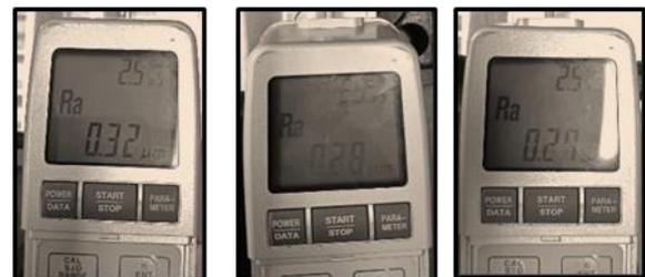
Hasil dari pengujian *specimen* 3 menggunakan parameter *spindle speed* 1700 rpm, *feed rate* 350 mm/menit, *depth of cuts* 0,2 mm dapat dilihat pada tabel 7.
