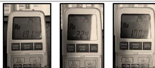
Hasil dari pengujian nilai kekasaran permukaan pada proses *finishing* menggunakan pisau *frais endmill* pada *specimen* bahan aluminium 6061 menggunakan mesin CNC *milling* dengan variasi *spindle speed* yang diukur dengan *surface roughness tester* ditunjukkan pada grafik berikut.
