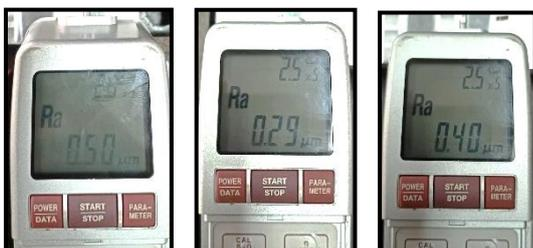
Hasil dari pengujian *specimen* 2 menggunakan parameter *spindle speed* 1500 rpm, *feed rate* 350 mm/menit, *depth of cuts* 0,2 mm dapat dilihat pada tabel 6.
