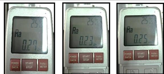
Hasil dari pengujian kekasaran permukaan pada proses *finishing* menggunakan pisau *frais fly cutter* pada *specimen* uji bahan aluminium 6061 menggunakan mesin CNC *milling* dengan variasi *spindle speed* yang diukur dengan *surface roughness tester* ditunjukkan pada grafik berikut :
