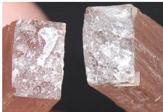
Gambar 7. Pola Patahan Komposit Uji Tarik Fraksi Volume 0 % Serat
