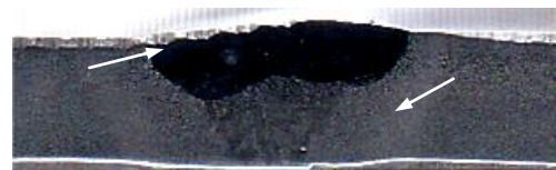
Gambar 8. Daerah Root Pass, Cover Pass dan HAZ
