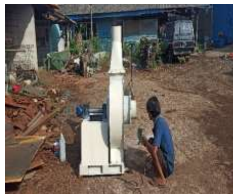
Gambar 3. Pekerja melakukan proses pengecatan blower .
