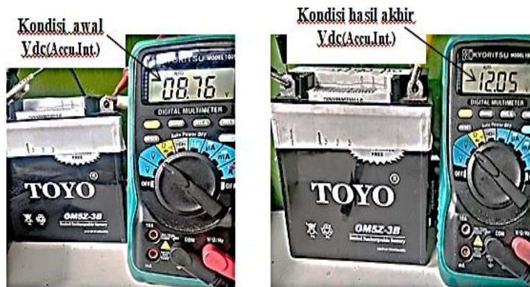
Gambar 12. Tegangan listrik dc internal kondisi awal dan kondisi setelah pengisian.
