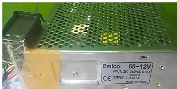
Gambar 2. Konverter ac mengkonversikan input listrik ac ke listrik dc
