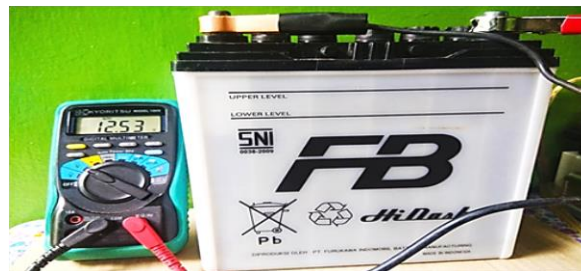
Gambar 5. Akumulator dc cadangan sebagai sumber input peralatan.
