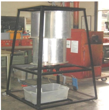
Gambar 8. Model pompa dengan penggerak turbin angin buatan Bondan (2007)
