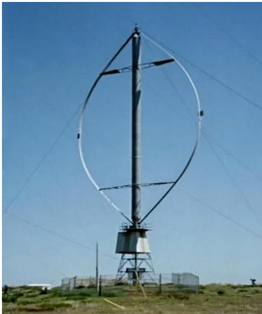
Gambar 4. Turbin angin Darrius termasuk jenis sumbu poros vertikal
