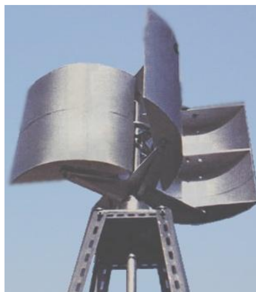
Gambar 3. Turbin angin Savonius termasuk jenis sumbu poros vertikal.
