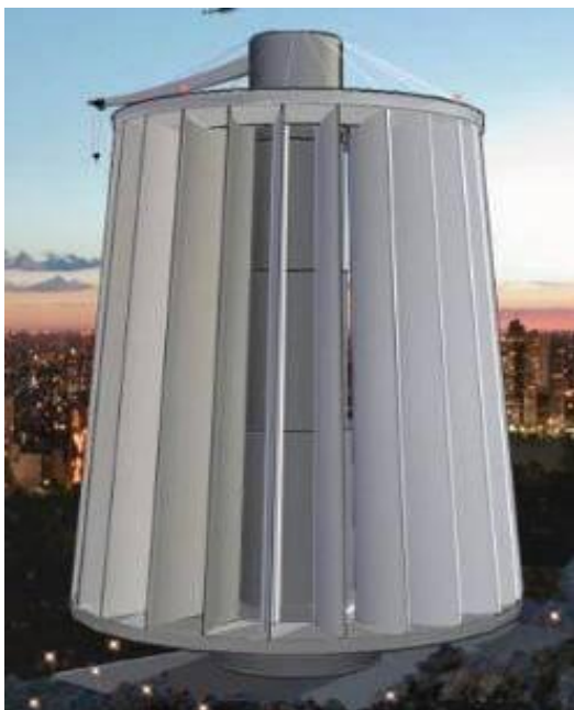
Gambar 4. Turbin angin Darrius termasuk jenis sumbu poros vertikal
