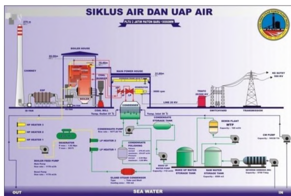
Gambar 2.1 Proses Produksi Listrik PLTU Paiton Unit 9 (Sumber : PLTU Paiton Unit 9)
