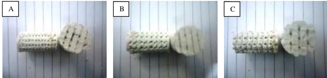
Gambar 2. Gambar bone scaffold yang dihasilkan melalui metode indirect fused deposition modeling . A: BG1b-90a, B: BG1b-90b, C: BG1b-90c.
