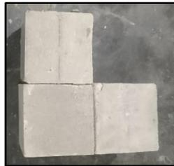
**Gambar 4. Benda Uji di Keluarkan dari Cetakan**
