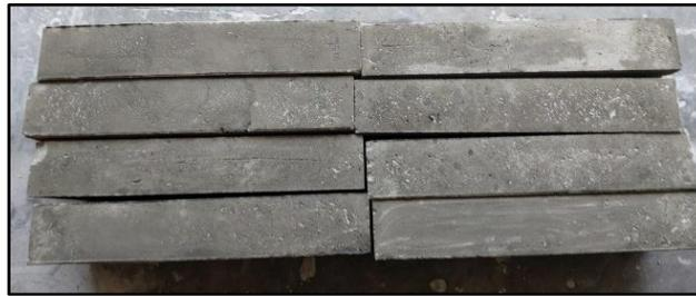
**Gambar 6. Benda Uji Bata Ringan Keluarkan dari Cetakan**
