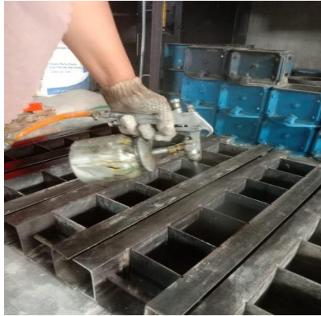
Gambar 2. Penyemprotan Oli pada Cetakan
