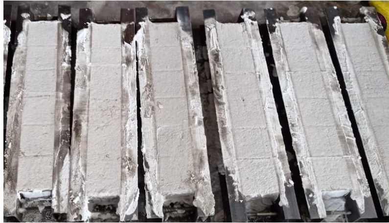
Gambar 7. Perawatan Benda Uji
