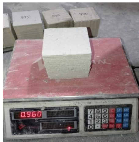
Gambar 9. Menimbang Benda Uji
