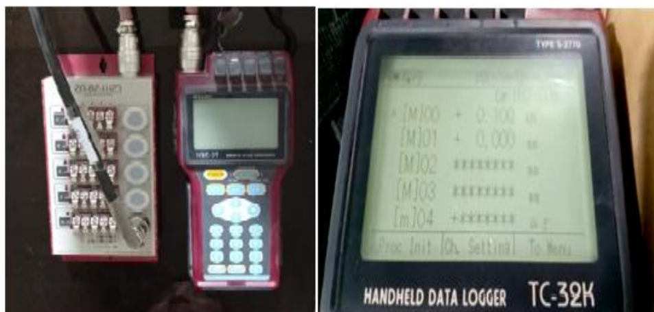
Gambar 12. Mengamati Hasil Uji Kuat Tekan
