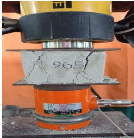
Gambar 11. Mengoperasikan Mesin Uji Kuat Tekan
