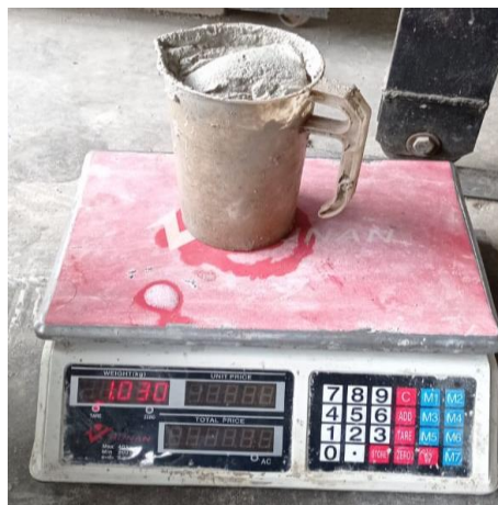
Gambar 6. Menimbang Densitas Basah
