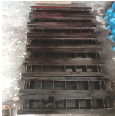
Gambar 3. Cetakan Setelah di Semprotkan dengan Oli
