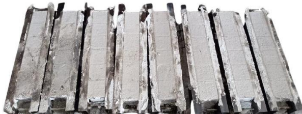
Gambar 5. Proses pengeringan benda uji didalam cetakan
