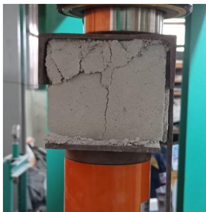
Gambar 9. Pengujian Kuat Tekan Bata Ringan P1
