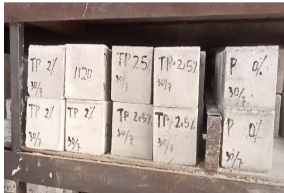
Gambar 8. Perawatan Bata Ringan
