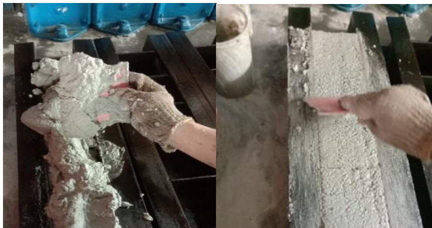
Gambar 7. Pencetakan Bata Ringan
