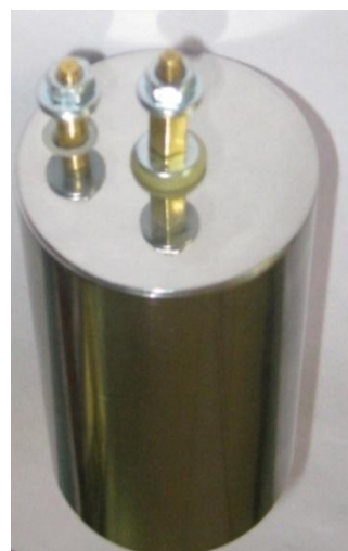
Gambar 5b. Konstruksi resistor shunt dalam kemasan
