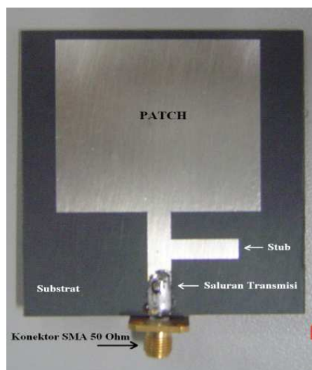
Gambar 2. Prototip antenna mikrostrip satu elemen patch[8].
