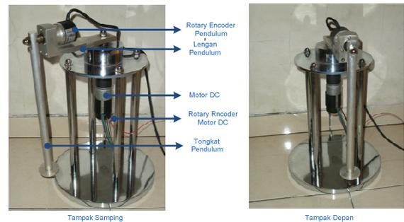
Gambar 7. Hasil rancang bangun Rotari Inverted Pendulum
