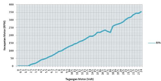
Gambar 12. Gambar hubungan antara tegangan motor terhadap kecepatan motor
