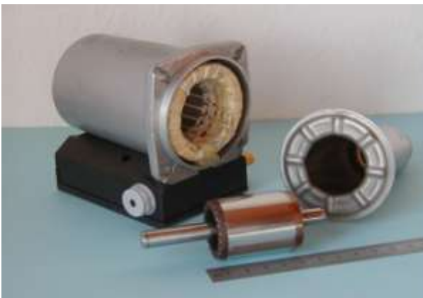
Gambar 1. Motor dua-fasa menggunakan kapasitor untuk aplikasi pompa sirkulasi fluida
