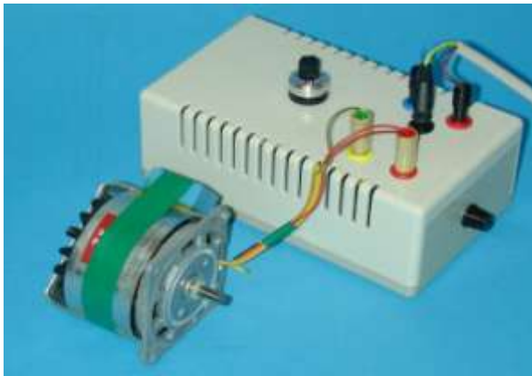
Gambar 12. Sebuah motor kapasitor yang dilengkapi dengan prototipe sistem TRIACS sebagai pengatur tegangan masukan
