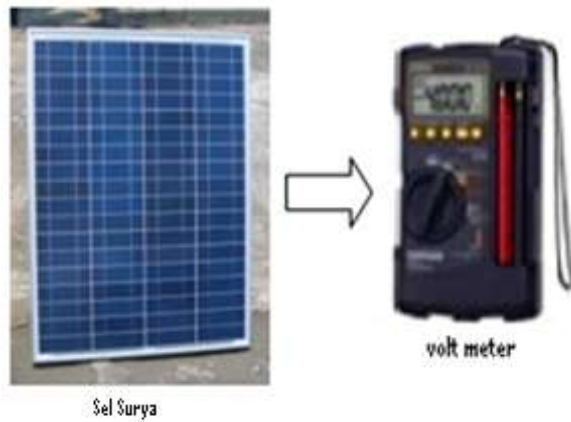
Gambar 5. Pengukuran Tegangan Output panel surya
