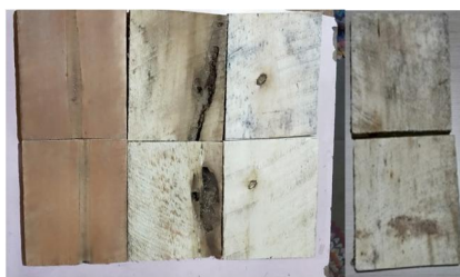
Gambar 2. Cacat pada Papan Kayu
