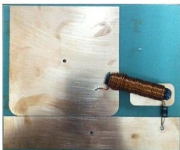
Gambar 11 Kaskade arester dengan elemen dekoupling
