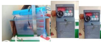
Gambar 10. Kondisi volume reservoir setengah , Frekuensi 35 Hz, Tegangan 170,7 Volt, VSD mode Medium Speed
