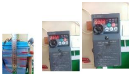
Gambar 9. Kondisi Volume Reservoir penuh, Frekuensi 50 Hz, Tegangan 237.7 Volt, VSD mode high Speed
