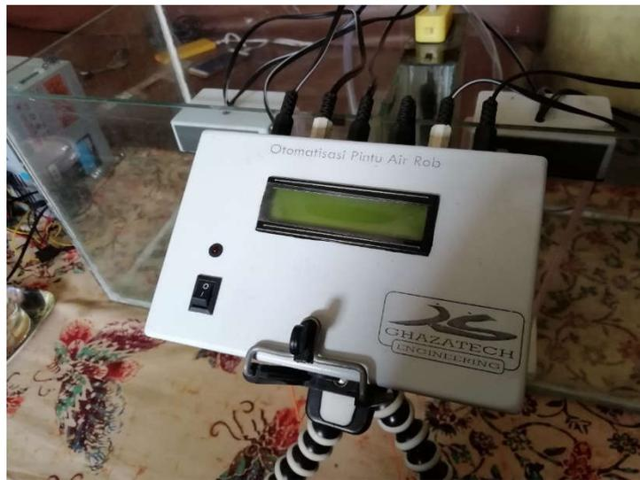
**Gambar 2.** Foto Alat Prototipe Otomatisasi Pintu dan Pompa Air
