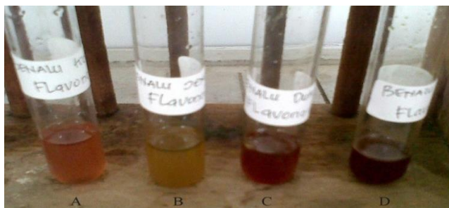
Gambar 2. Hasil Uji Fitokimia Senyawa Flavonoid (A) Benalu kopi, (B) Benalu Jengkol, (C) Benalu Duku, (D) Benalu Mangga dengan Sianidin Test
