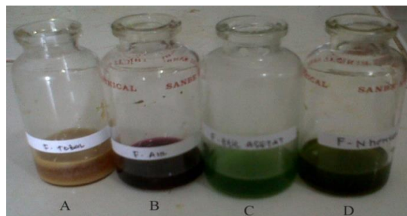
Gambar 3. Uji Senyawa Flavonoid dengan Sianidin Test dari (A) Ekstrak Total, (B) Fraksi Air, (C) Fraksi Etil Asetat dan (D) Fraksi n-Heksan.
