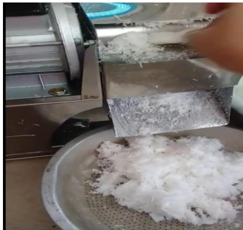
Gambar 2. Penggunaan Mesin Parut Kelapa Listrik
