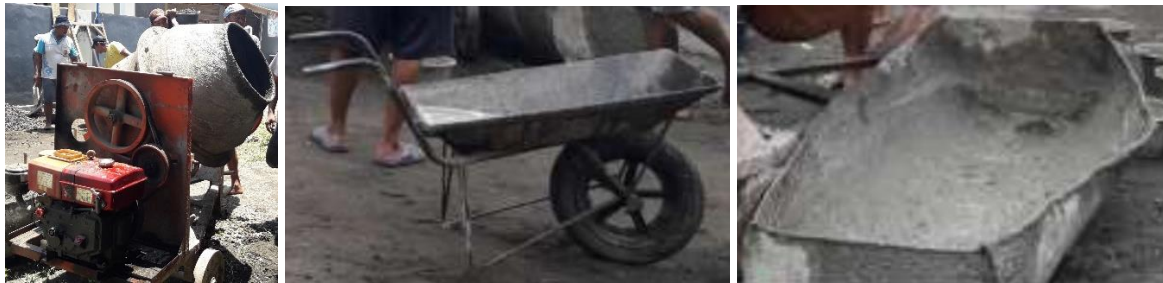
Gambar 4. Alat Pengaduk Beton (Molen), Angkong, dan Penampung Beton.
