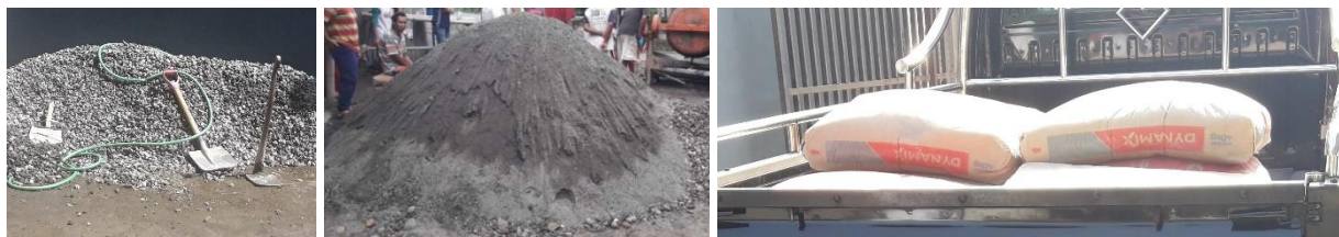
Gambar 5. Material Pembuat Beton : Koral, Pasir dan Semen
