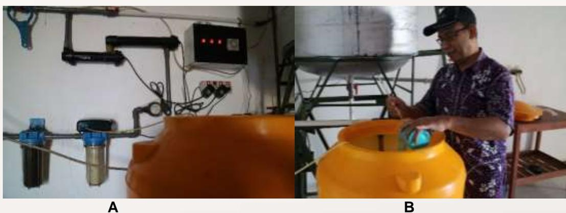
Gambar 3. Persiapan media produksi; A: perangkat sterilisasi UV lamp dan ozonisasi dan B: penuangan media produksi pada chamber media
