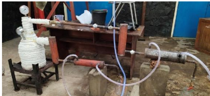
Gambar 2 Alat Pengolahan Limbah Oli Bekas Menjadi Bahan Cair Diesel Dengan Perlakuan Panas
