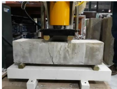
Gambar 4. Uji Lentur Balok Sumber : Dokumentasi Peneliti, 2021
