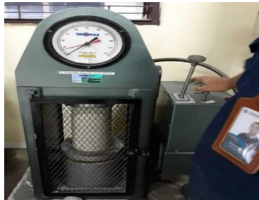
Gambar 3. Uji Silinder Beton Sumber : Dokumentasi Peneliti, 2021
