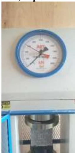
**Gambar 4.6** Pengujian kuat tekan beton
