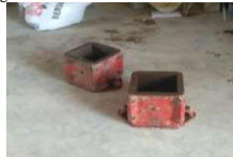
**Gambar 4.9 cetakan beton kubus Peralatan**
