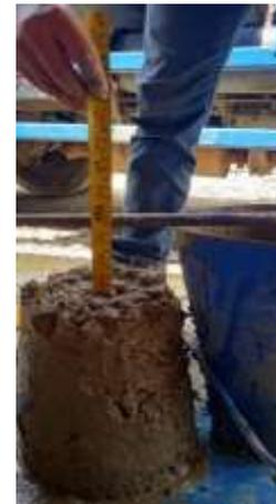
**Gambar 4.8 Pengujian Slump Test Pengujian Kuat Tekan Beton**
