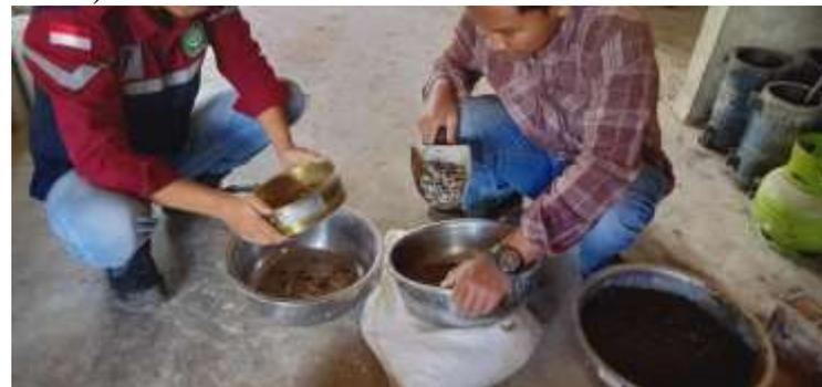
**Gambar 4.3** Pengujian sample lolos uji saringan 200
