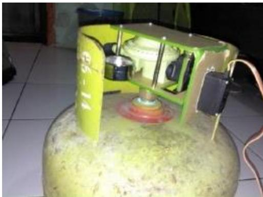
**Gambar 10.** Pemasangan Sensor gas pada tabung gas LPG
